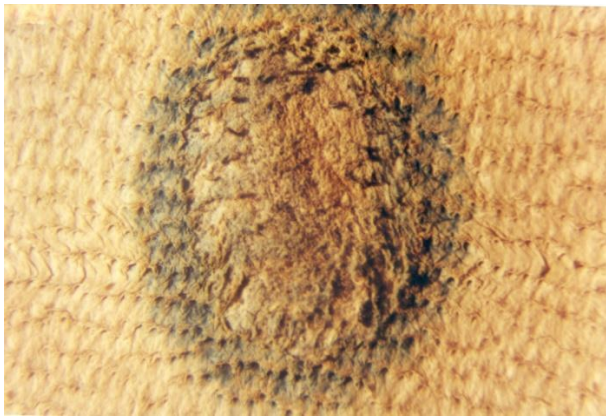
Figura 1. Pelle wet-blue con attacco batterico. Foto microscopio ottico
