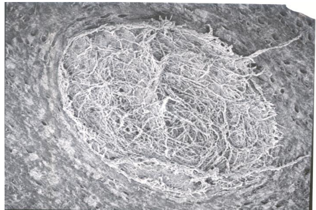
Figura 2. Pelle wet-blue con attacco batterico. Foto al SEM
